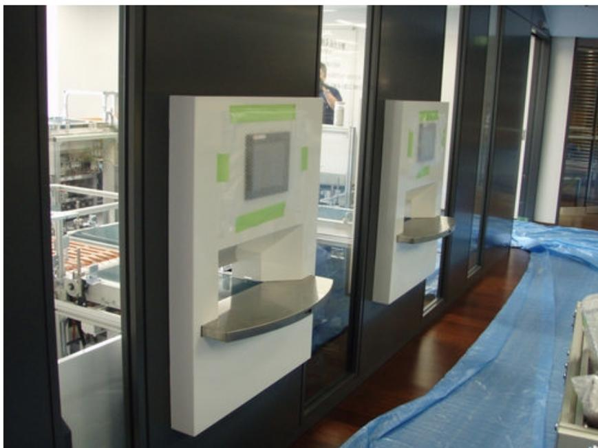
③自動返却機の投入口です。コンベアに資料を載せると自動的に中に吸い込まれていき、返却処理が行われます。部屋はガラス張りになっていますので、中の様子をご覧いただけます。
